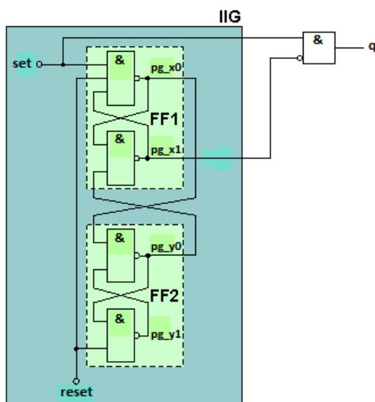
Dazu habe ich Ihr ideales Impulsglied mit NICHT-UND-Gliedern aufgebaut und um ein UND-Gatter ergänzt. Das Taktsignal clk wird sowohl dem Impulsglied über den Eingang set als auch dem UND-Gatter zugeführt. Das Freigabesignal wird dagegen vom Ausgang pg\_x1 abgeleitet und invertiert an den anderen Eingang des UND-Gatters gelegt.
