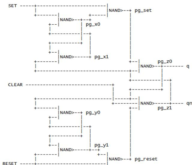
Die Impulsfolge in der Testumgebung habe ich etwas abgeändert, um die Wirkung des Freigabeeinganges clear zu demonstrieren. Dort erhält set bereits H-Signal, bevor clear = H ist, um danach wieder L-Signal anzunehmen. Es ergibt sich dadurch für Version #1 nun folgendes Impulsdiagramm:
