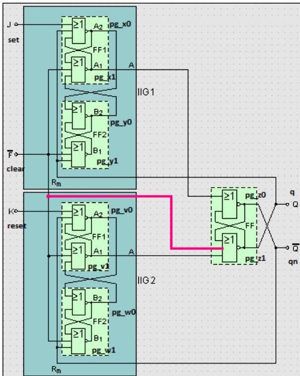
Weist nun der Freigabeeingang F während des Einschaltens H-Signal auf, erhalten die Ausgänge der Eingangs-FFs  $pg\_x1$ ,  $pg\_y1$ ,  $pg\_v1$ ,  $pg\_w1$  sowie  $pg\_z1 (= q)$  L-Signal.  $pg\_z0 (= qn)$  erhält wegen  $pg\_x1 = L$  und  $pg\_z1 = L$  deshalb H-Signal.
