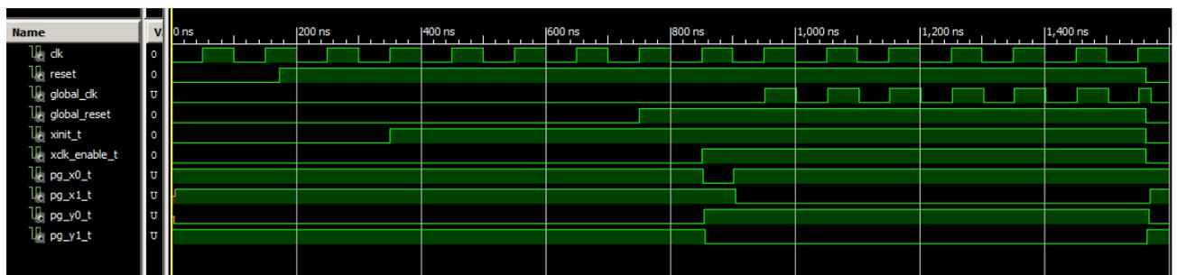
Deutlich erkennbar ist, dass der erste Taktimpuls in `global_clk` nicht abgeschnitten wird. Beim letzten Taktimpuls spielt dies dagegen keine Rolle und ist unkritisch, da `global_reset` bereits L-Signal angenommen und damit die weitere Schaltung zurückgesetzt hat.
