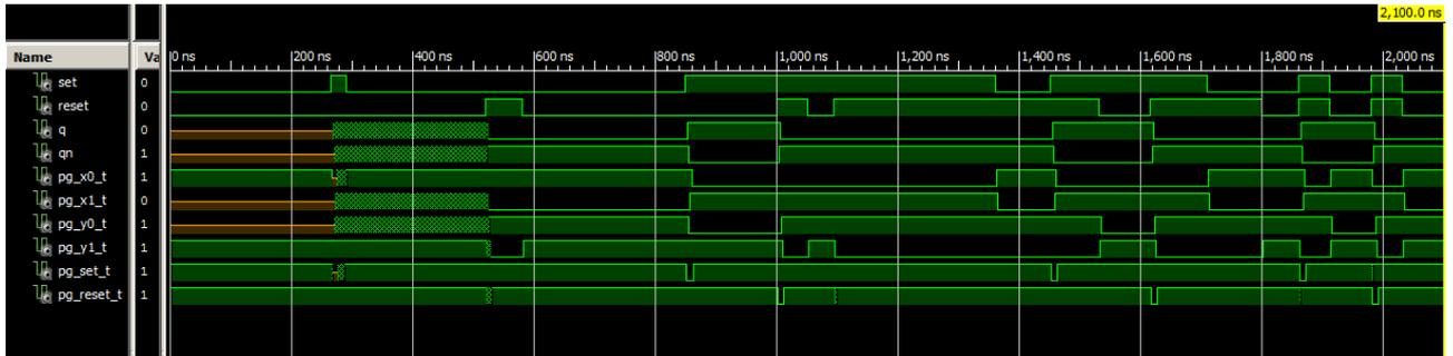
Basierend auf der Überlegung mit dem Freigabeeingang bei Ihrem JK-FF habe ich das Gatter pg\_z1 vom Ausgangs-FF (pg\_z0 / pg\_z1) um einen weiteren Eingang ergänzt. Über diesen zusätzlichen Eingang wird jetzt das Freigabesignal clear zugeführt. Die Freigabe erfolgt erst dann, wenn clear = H ist. Damit sollte ein eindeutiger Zustand von Anfang gewährleistet sein. Nachfolgend der abgeänderte VHDL-Quellcodeausschnitt in der Version #1:
