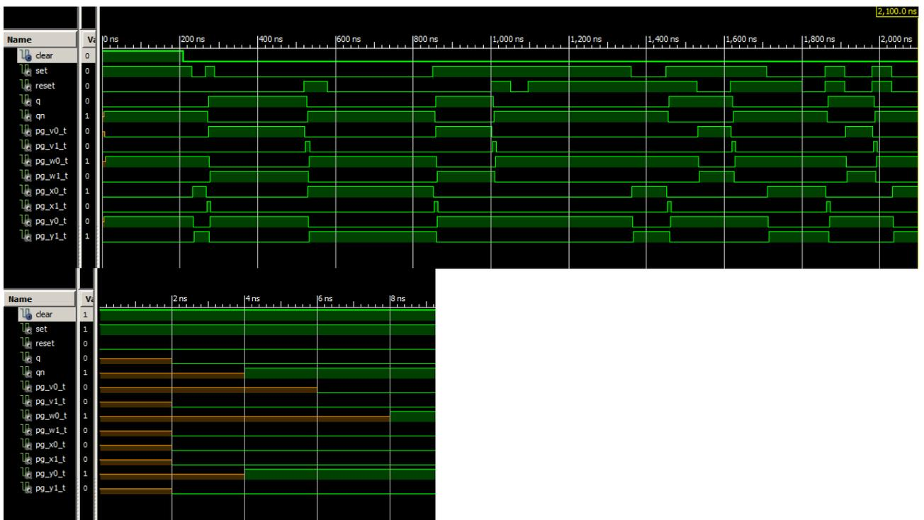
Die ersten 8 Nanosekunden benötigt das JK-FF bis zur vollständigen Stabilisierung aufgrund der Gatterlaufzeiten. Danach zeigt es ein definiertes und korrektes Verhalten. Es ist also wichtig, das Ausgangs-FF (pg\_z0 / pg\_z1) ebenso mit dem Freigabesignal F (clear) zurückzusetzen. Hier der VHDL-Codeausschnitt für das von mir ergänzte JK-FF:
